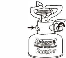
点火しない場合は器具栓ツマミを右(-)方向に回し、一度ガスを止め、また点火操作を最初からやり直してください。
