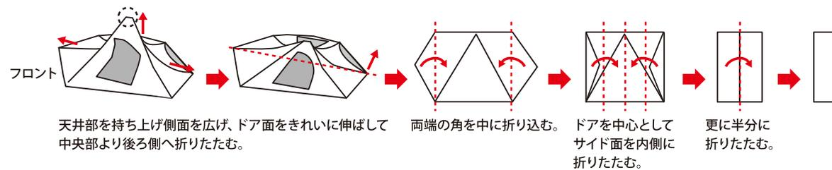
**3** ポールを全ておりたたみポールケースに収納し、本体を下図のように巻いて、キャリーバッグに収納して完了です。
