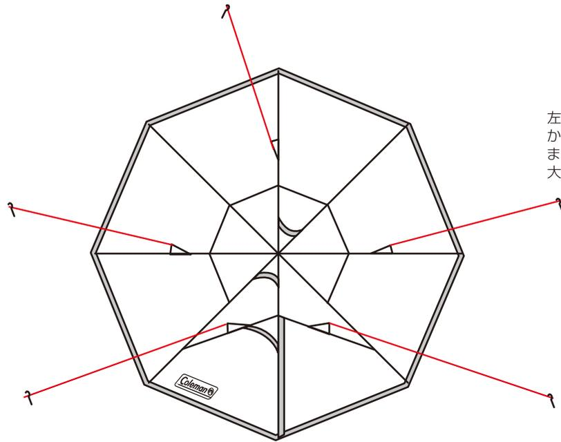
左図の要領にて5ヶ所にロープをセットし、本体から約1m程離れた位置にペグ打ちして固定します。自在をしめあげて、ポールが前後左右に大きく動かないように調節してください。
