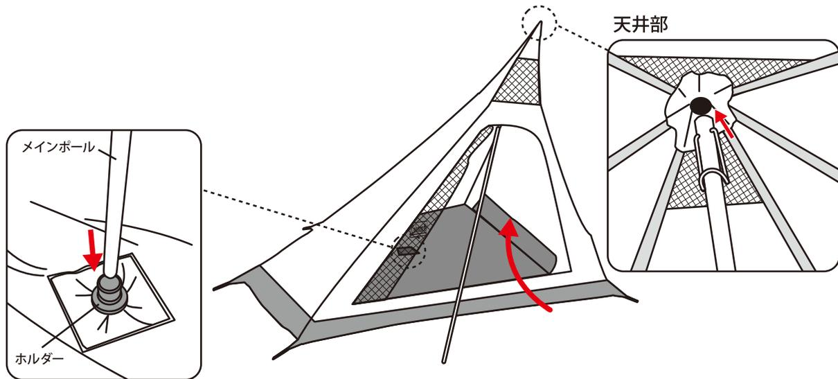
立ち上がった後、メインポール反対側をフロア中央部のホルダーに差し込みます。
