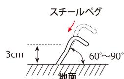
ペグは引かれる方向の反対側へ60°~90°の角度に打ち込むと風に対して強く設営できます。
