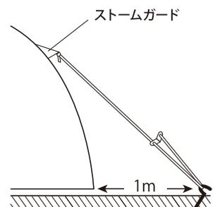
自在ロープの端をストームガードのループに結びます。ペグを打ち、ロープをかけて自在をしめロープの長さを調節します。
