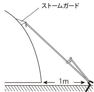
自在ロープの端をストームガードのループに結びます。ペグを打ち、ロープをかけて自在をしめロープの長さを調節します。
