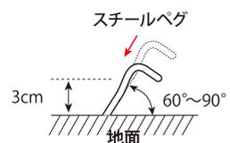
ペグは引かれる方向の反対側へ60°~90°の角度に打ち込むと風に対して強く設営できます。
