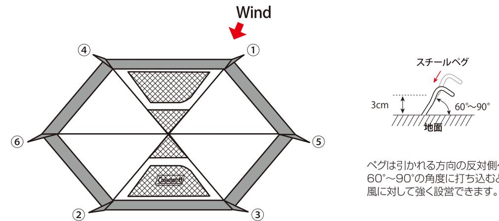
ペグは引かれる方向の反対側へ60°~90°の角度に打ち込むと風に対して強く設営できます。
