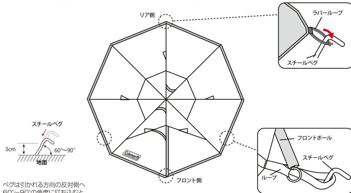
ペグは引かれる方向の反対側へ60°~90°の角度に打ち込むと風に対して強く設営できます。
