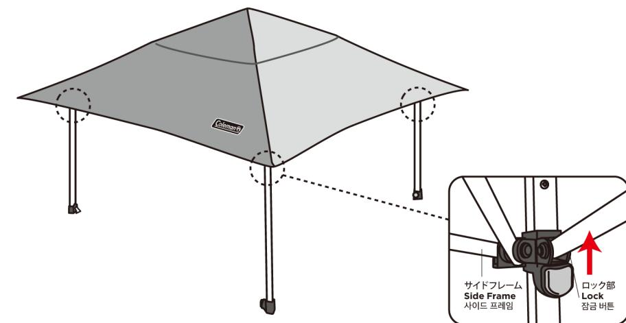
ロック部は必ず上部まで押し上げ、カチッとはまるのを確認してください。このとき指を挟まないように注意してください。また、ロックを解除する際の操作は必ず手で行ってください。ロックが固い場合は、フレームを手で押し上げながら解除してください。
