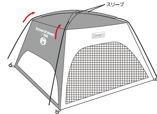
**⚠** ポールを通す際は必ずスリーブを持って押し込んでください。スリーブを持たずに押し込んだり、ポールを引き入れたりしますと、ポールやスリーブが破損するおそれがあります。また、立ち上げの際にはポールのはね返りにお気をつけてください。
