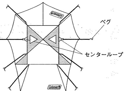
上図の要領にて8ヵ所にロープをセットし、本体から約1m程離れた位置にペグ打ちして固定します。
