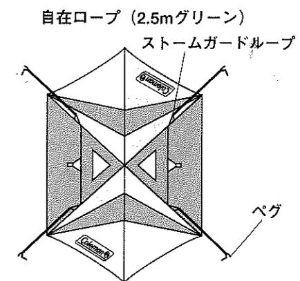
上・左図の要領にて6ヶ所にロープをセットし、本体から約1m程離れた位置にペグ打ちして固定します。
