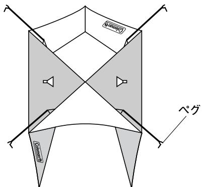
上図の要領にて6ヵ所にロープをセットし、本体から約1m程離れた位置にペグ打ちして固定します。
