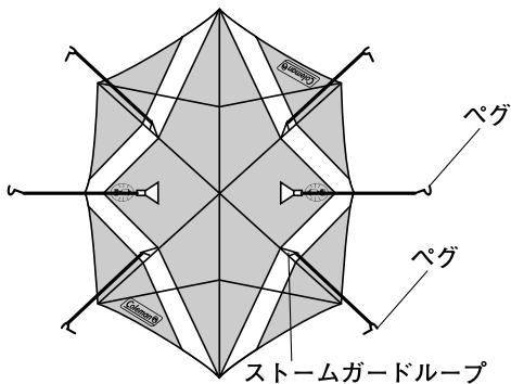
上図の要領にて6ヵ所にロープをセットし、本体から約1m程離れた位置にペグ打ちして固定します。
