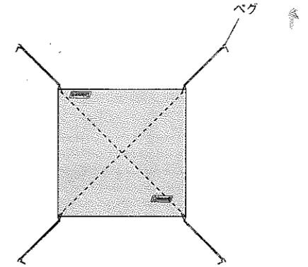
上・左図の要領にて4ヶ所にロープをセットし、本体から約1m程離れた位置にペグ打ちして固定します。
