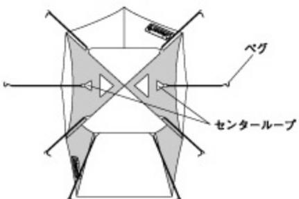
上図の要領にて8ヵ所にロープをセットし、本体から約1m程離れた位置にペグ打ちして固定します。
