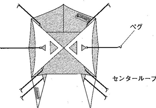
上図の要領にて8ヵ所にロープをセットし、本体から約1m程離れた位置にペグ打ちして固定します。
