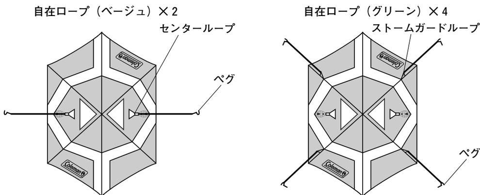
上・左図の要領にて6カ所にロープをセットし、本体から約1m程離れた位置にペグ打ちして固定します。自在をしめあげて、ポールが前後左右に大きく動かなくなるよう調節してください。
