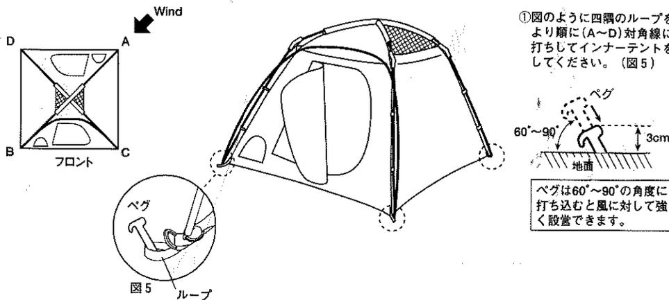
①図のように四隅のループを風上より順に(A~D)対角線にペグ打ちしてインナーテントを固定してください。(図5)
