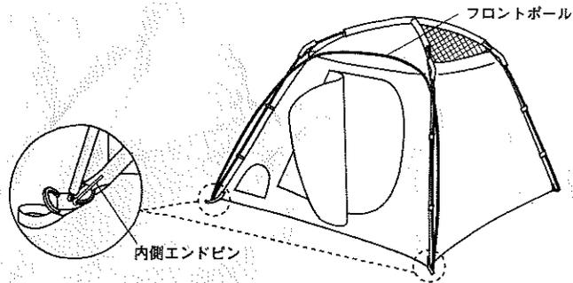
①フロントポールをフロントドア側のコーナー2ヶ所に残っている内側エンドピンに差し込みます。
