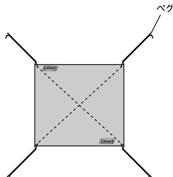
上・左図の要領にて4ヵ所にロープをセットし、本体から約1m程離れた位置にペグ打ちして固定します。
