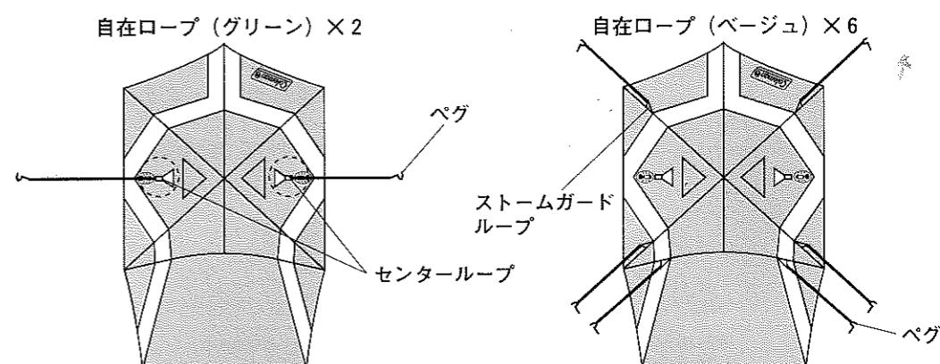
上・左図の要領にて8ヶ所にロープをセットし、本体から約1m程離れた位置にペグ打ちして固定します。
