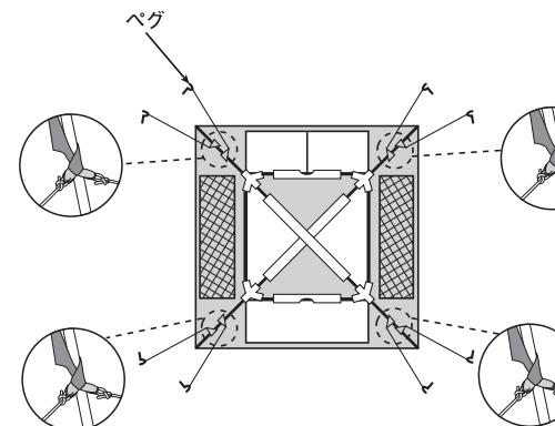
左図の要領にて8ヵ所にロープをセットし、本体から約1m程離れた位置にペグ打ちして固定します。その際、ロープはポールを挟むように交差してペグ打ちしてください。自在をしめあげて、ポールが前後左右に大きく動かなくなるよう調節してください。
