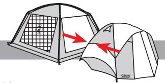
本製品は、コールマン製のキャノピータイプのテントとのジョイントが可能です。ジョイントはタープ設営後に以下の手順で行います。
