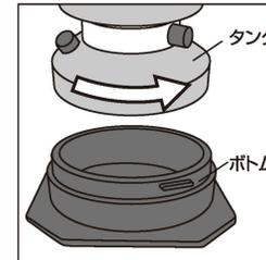
①電源をOFFにして、ボトムを回して本体のタンクから分離してください。
