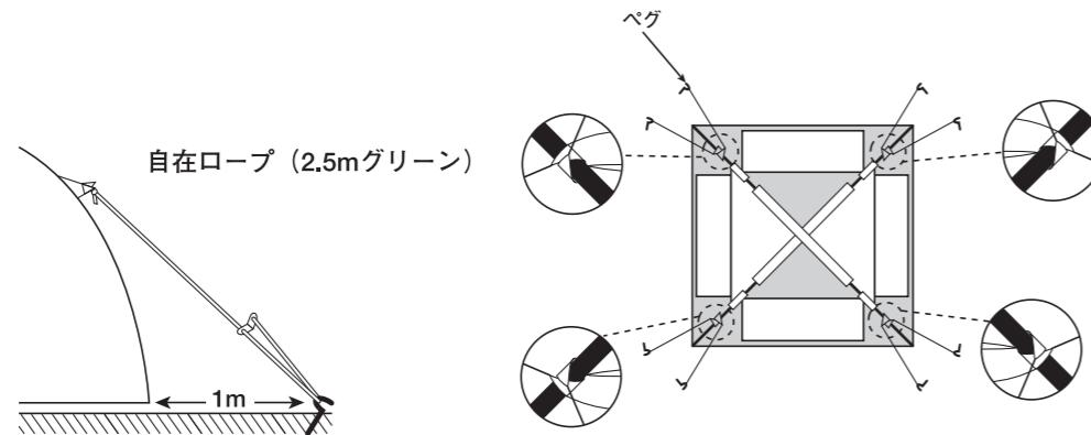
自在ロープの端をストームガードのループ(8ヶ所)に結び、右図のようにポール(4ヶ所)を巻き込むようにしてロープをしめあげ、ポールが前後左右に大きく動かなくなるように調節し終えたら、ロープの端を本体から約1m程離れた位置にペグ打ちして固定します。
