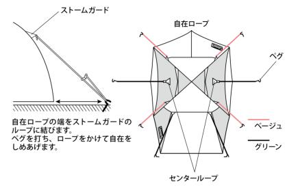
左図の要領にて8ヵ所にロープ をセットし、本体から約1m程離 れた位置にペグ打ちして固定し ます。
