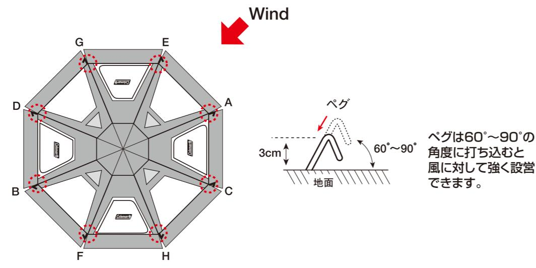
ストームガードに自在ロープ(8本)を取り付けペグで固定します。
