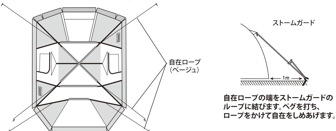
上・右図の要領にて6ヶ所にロープをセットし、本体から約1m程離れた位置にペグを打ち込み固定します。
