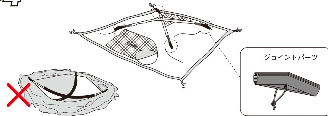
**注意** ジョイントパーツの上下の向きに注意してください。内側にギザギザの付いている方が上（ルーフポール）側です。
