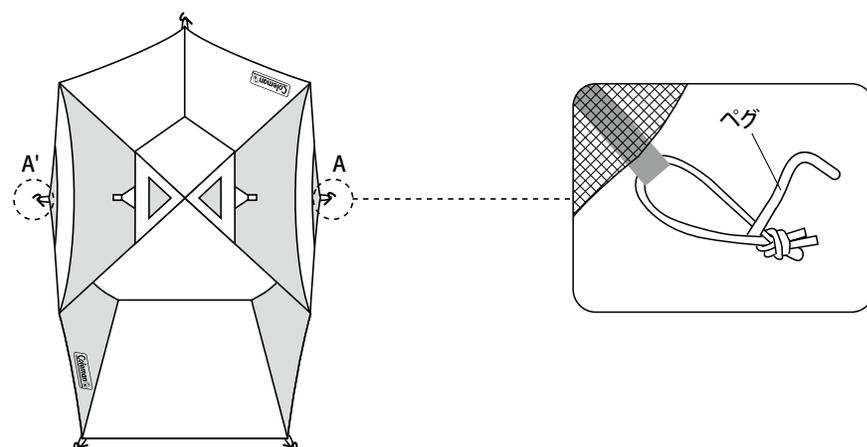
**注意** フライシートはテントインナー室内と外気との温度差を緩和し、テント内側の結露を防止する役割を果たしています。センターループ・ストームガードを張り、フライシートとインナーテントの間に空間をつくるように、必ずご活用ください。
