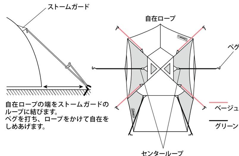
左図の要領にて8カ所にロープをセットし、本体から約1m程離れた位置にペグ打ちして固定します。自在をしめあげて、ポールが前後左右に大きく動かなくなるよう調節してください。
