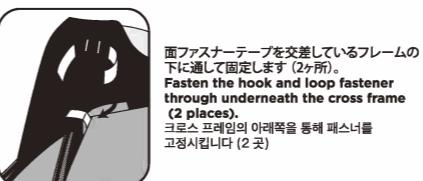
面ファスナーテープを交差しているフレームの下に通して固定します(2ヶ所)。
