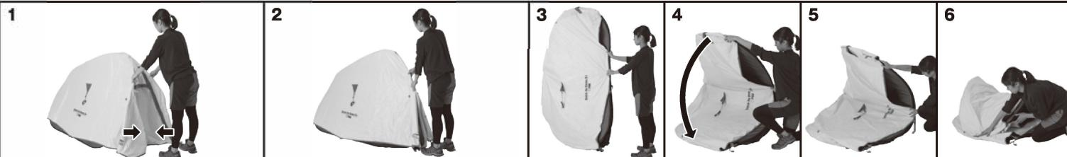
テントを固定したペグを全て外し、インナーテントのジッパーを一部開けて(たたむ時に内部の空気が抜けやすくなるため)、左右のフレームを合わせてたたみます。
