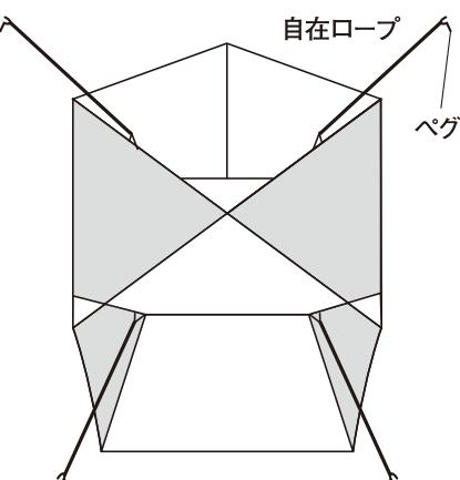
上図の要領にて4ヵ所にロープをセットし、本体から約1m程離れた位置にペグ打ちして固定します。
