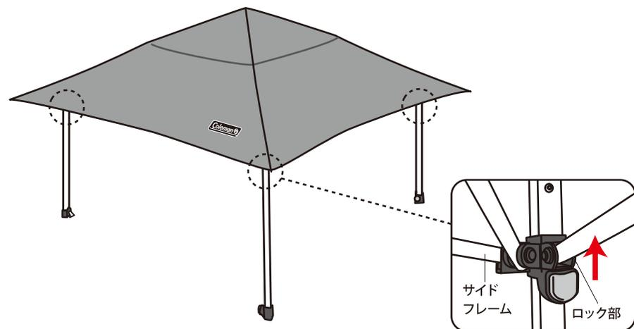
**!** ロック部は必ず上部まで押し上げ、カチッとハマるのを確認してください。このとき指を挟まないように注意してください。また、ロックを解除する際は必ず手で行ってください。ロックが固い場合は、サイドフレームを手で押し上げながら解除してください。
