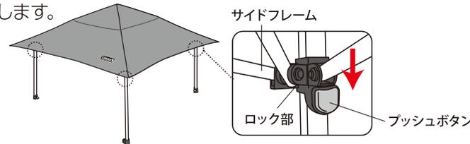
**注意** ロックを解除する際、指を挟まないように注意してください。また、ロックを解除する際の操作は必ず手で行ってください。ロックが固い場合は、サイドフレームを手で少し押し上げながらプッシュボタンを押してロックを解除してください。
