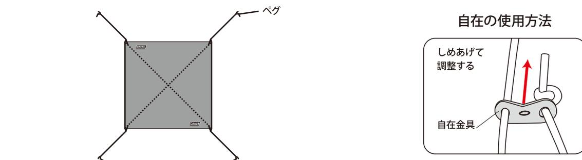
図の要領にてロープをセットし、本体から約1m程離れた位置にペグ打ちして固定します。自在をしめあげて、ボールが前後左右に大きく動かなくなるよう調節してください。
