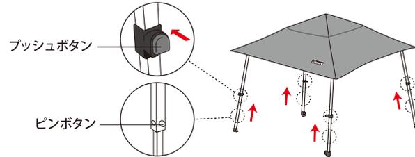
4 各コーナーのロック部のプッシュボタンを押して、ロックを解除してフレームを中心方向に縮めます。本体フレームからシェードスキンを外します。
