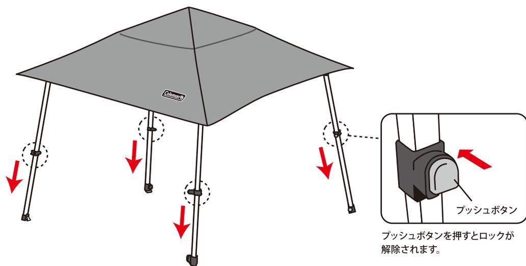
**!** 4本の脚部が確実にロックされ、地面と平行になっているか確認します。
