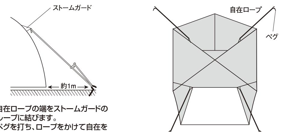
上図の要領にて4ヵ所にロープをセットし、本体から約1m程離れた位置にペグ打ちして固定します。
