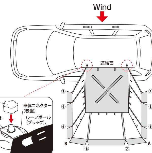
④2ヶ所のループ(A・B)にプラスチックペグを打ち、本体を固定してください。次にラバーループを張出し、図のように8ヶ所を順に(①~⑧)にスチールペグを打ち、本体を固定してください。
