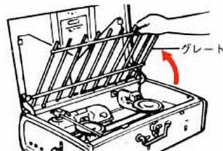
③ジェネレーター先端を、本体凹部を通して外に出し、ジェネレーター先端を上にした角度で燃料タンクを取り出す。
