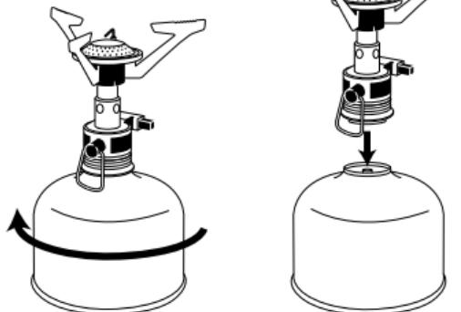
③バーナーヘッドを矢印の方向に回し、器具栓本体と分離します。ごとくは、たたんだ状態で保管してください。
