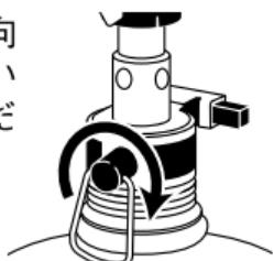
②本体を押さえて、ガスカートリッジ(容器)を右(時計)方向に回して、垂直に外してください。
