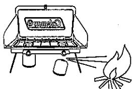
3. 使用中、玉ねぎの腐ったようなにおいがしたら、ガス漏れを起こしています。すぐに換気を充分にしてください。LPガスは比重が重く下部にたまります。
