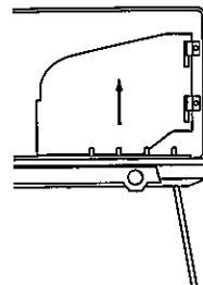
③風防に付いているクリップを本体の側面の差し込み穴に差し込み固定します。
