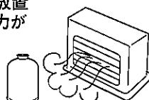
3. ガスカートリッジ(容器)を火中に投じないでください。熱で容器の圧力が上がり爆発の原因となります。
