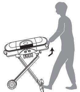
脚をたたみ、本体をゆっくり降ろします。脚の中心部を本体裏のブラケットにはめ込むようにして、固定します。
