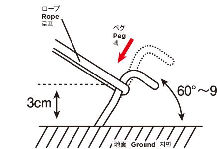
**!** ペグは上図のように引かれる方向の反対側へ地面から60°～90°の角度で打ち込みますと、風に対して強く設営できます。
