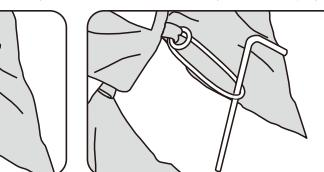
ペグは引かれる方向の反対側へ60°~90°の角度に打ち込むと風に対して強く設営できます。
