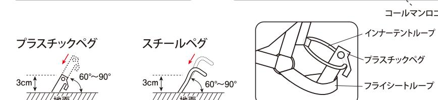
ペグは引かれる方向の反対側へ60°~90°の角度に打ち込むと風に対して強く設営できます。
