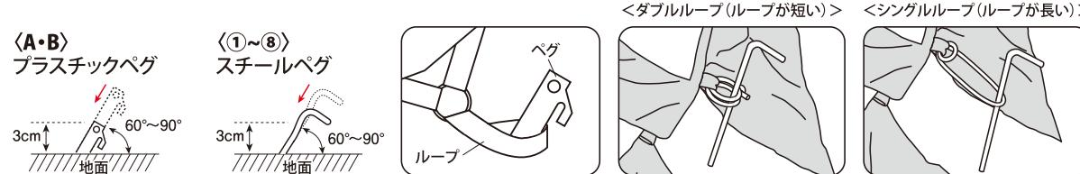
ペグは引かれる方向の反対側へ60°~90°の角度に打ち込むと風に対して強く設営できます。
