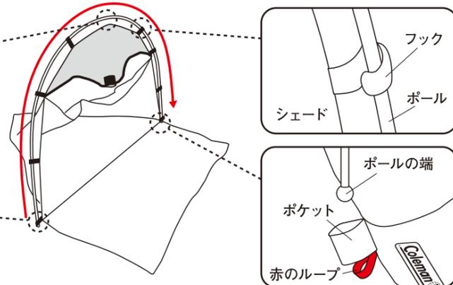
**注意** ポールの端をポケットに収納する際は、ポールの端をポケットに完全に収納してください。収納が浅い場合、ポールが折れる可能性があります。
