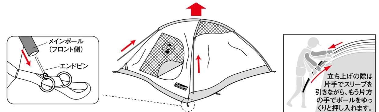
**注意** メインポールは2人で2本同時に、徐々に立ち上げてください。立ち上げの際は片手でスリーブを引きながら、もう片方の手でポールをゆっくりと押し入れます。スリーブを持たずに押し込むと、ポールが折れたり生地が破れたりします。
