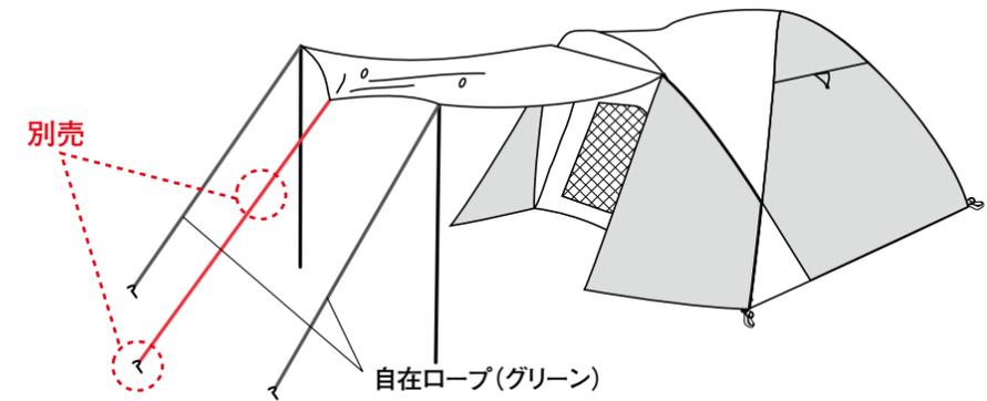
**注意** 雨天時にキャンピアーを活用する際は、水がたまりやすくなりますので、傾斜を作るか、中央部にロープ(別売)を結びペグ止めて雨水を流してください。
