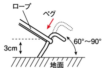
ペグは左図のように地面から引かれる方向の反対側へ60°~90°の角度で打ち込みますと、風に対して強く設営できます。
