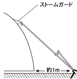
自在ロープの端をストームガードのループに結びます。ペグを打ち、ロープをかけて自在をしめロープの長さを調整します。
