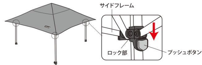
⚠ ロックを解除する際、指を挟まないように注意してください。また、ロックを解除する際、操作は必ず手で行ってください。ロックが固い場合は、サイドフレームを手で少し押し上げながらプッシュボタンを押してロックを解除してください。
