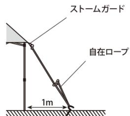
自在ロープの端をストームガードのループに結びます。ペグを打ち、ロープをかけて自在をしめロープの長さを調節します。
