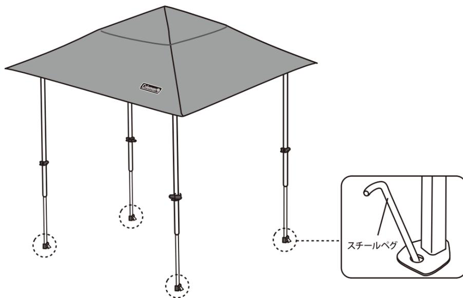
**7** ストームガードシステムはシェードの安定性を高めます。各コーナーに付属のロープを結び、図のようにペグで固定します。
