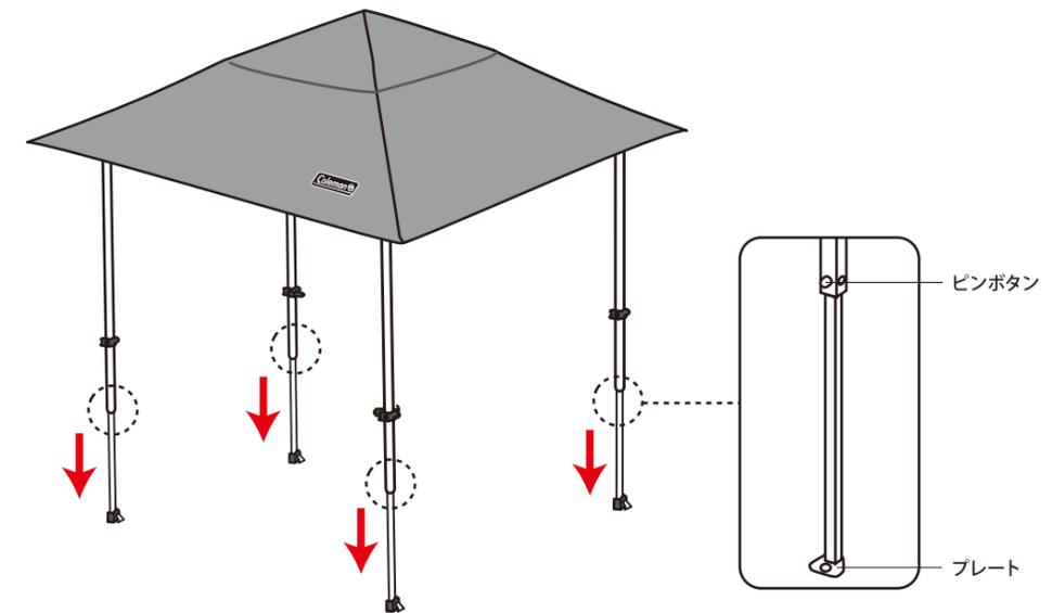
**!** 4本の脚部が完全にロックされ、地面と平行になっているか確認します。風がある時は脚部を伸ばさずに低い状態で設営するなど工夫をしてください。
