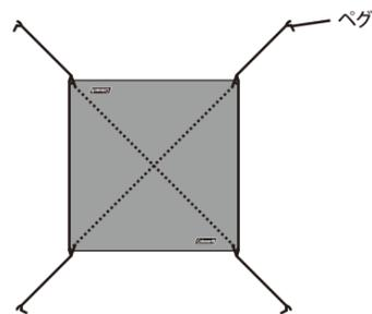
上図の要領にて4ヶ所にロープをセットし、本体から約1m程離れた位置にペグ打ちして固定します。自在をしめあげて、ポールが前後左右に大きく動かなくなるよう調節してください。
