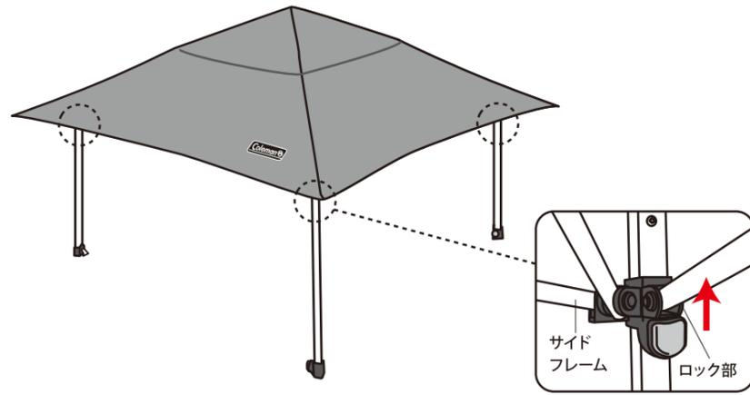
**!** ロック部は必ず上部まで押し上げ、カチッとハマるのを確認してください。このとき指を挟まないように注意してください。また、ロックを解除する際の操作は必ず手で行ってください。ロックが固い場合は、サイドフレームを手で押し上げながら解除してください。
