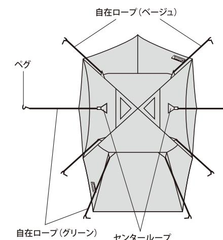
左図の要領にて8ヵ所にロープをセットし、本体から約1m程離れた位置にペグ打ちして固定します。自在をしめあげて、ポールが前後左右に大きく動かなくなるよう調節してください。
