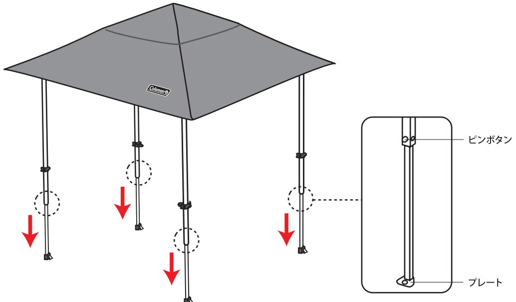
**⚠️** 4本の脚部が完全にロックされ、地面と平行になっているか確認します。
