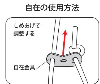
上図の要領にて4ヵ所にロープをセットし、本体から約1m程離れた位置にペグ打ちして固定します。
