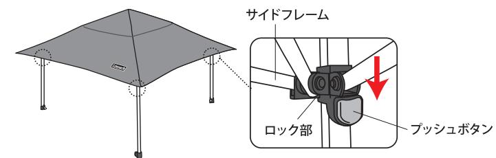
**!** ロックを解除する際、指を挟まないように注意してください。また、ロックを解除する際の操作は必ず手で行ってください。ロックが固い場合は、サイドフレームを手で少し押し上げながらプッシュボタンを押してロックを解除してください。
