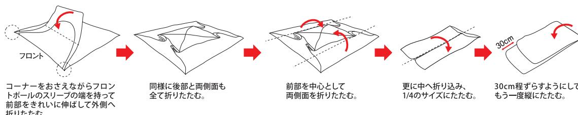
**2** ポールを全ておりたたみポールケースに収納し、シェードスキンを下図のように巻いて、キャリーバッグに収納して完了です。
