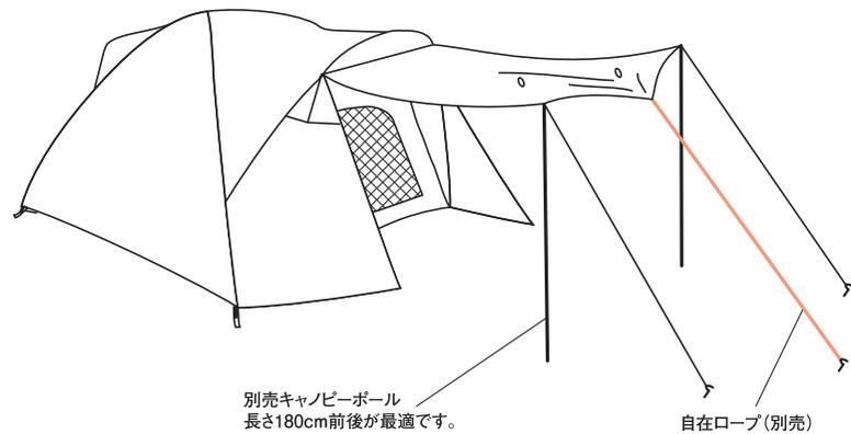
**!** 雨天にキャンピーとして活用する場合は水がたまりやすくなります。その際はキャンピーに傾斜を作るか、図のように中央部にロープを結びペグ止めて雨水を流してください。風の強い時は、必ずキャンピーを閉じてください。ポールが折れるおそれがあります。
