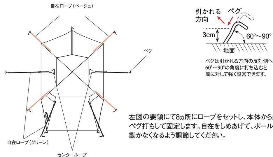
左図の要領にて8か所にロープをセットし、本体から約1m程離れた位置にペグ打ちして固定します。自在をしめあげて、ポールが前後左右に大きく動かなくなるよう調節してください。
