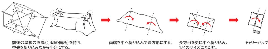
2 ポールをすべて外し、空気を逃がすためにフロント・バックドアの下部をあらかじめ開けておいてから、四隅をきれいに広げ四角形になった状態で、下図のようにしてたたみます。
