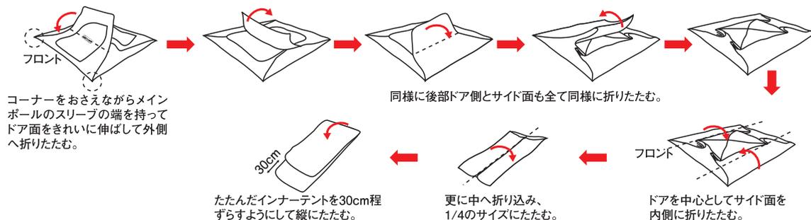
3 ポールを全ておりたたみポールケースに収納し、本体を下図のように巻いて、キャリーバッグに収納して完了です。
