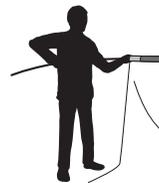
立ち上げの際は片手でスリーブを引きながら、もう片方の手でポールをゆっくりと押し入れます。スリーブを持たずに押し込むと、ポールが折れたり生地が破れたりします。
