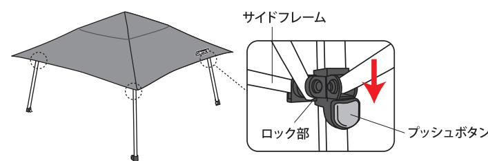
**!** ロックを解除する際、指を挟まないように注意してください。また、ロックを解除する際の操作は必ず手で行ってください。ロックが固い場合は、サイドフレームを手で少し押し上げながらプッシュボタンを押してロックを解除してください。
