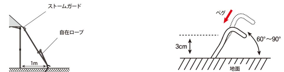
自在ロープの端をストームガードのループに結びます。ペグを打ち、ロープをかけて自在をしめロープの長さを調整します。
