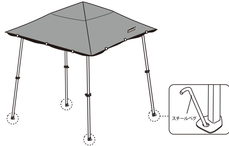
**5** ストームガードシステムはシェードの安定性を高めます。各コーナーに付属のロープを結び、図のようにペグで固定します。
