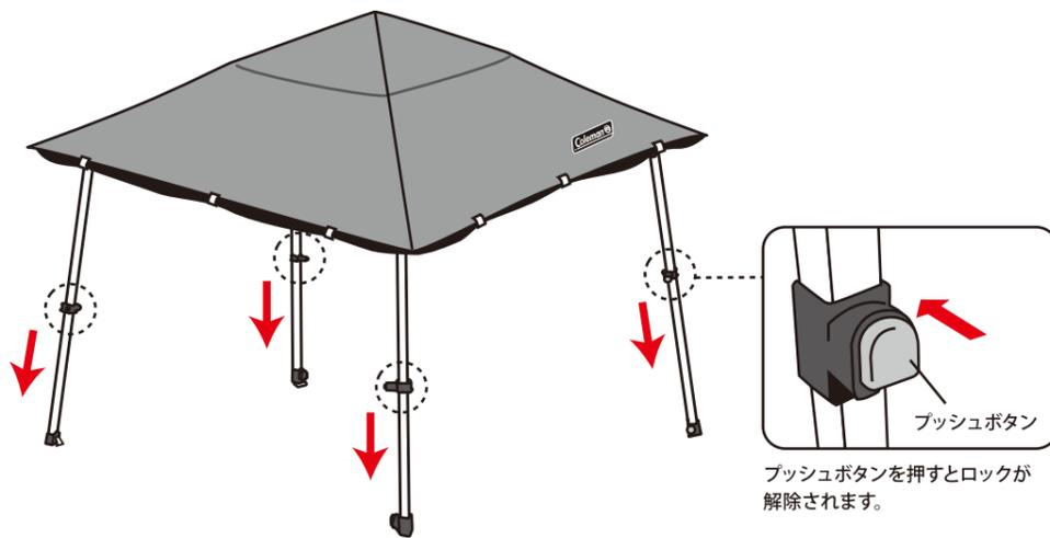
**!** 4本の脚部が確実にロックされ、地面と平行になっているか確認します。
