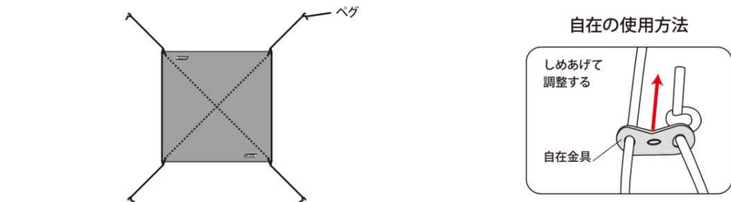
上図の要領にて4ヶ所にロープをセットし、本体から約1m程離れた位置にペグ打ちして固定します。自在をしめあげて、ボールが前後左右に大きく動かなくなるよう調整してください。
