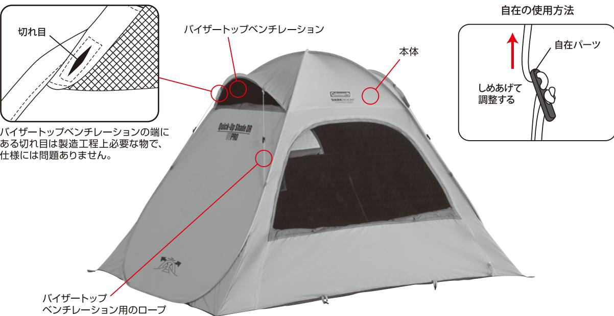
シェードを広げた後、左右のバイザートップベンチレーションを外側に張り出し、バイザートップベンチレーション用のロープをしめあげて調整します。
